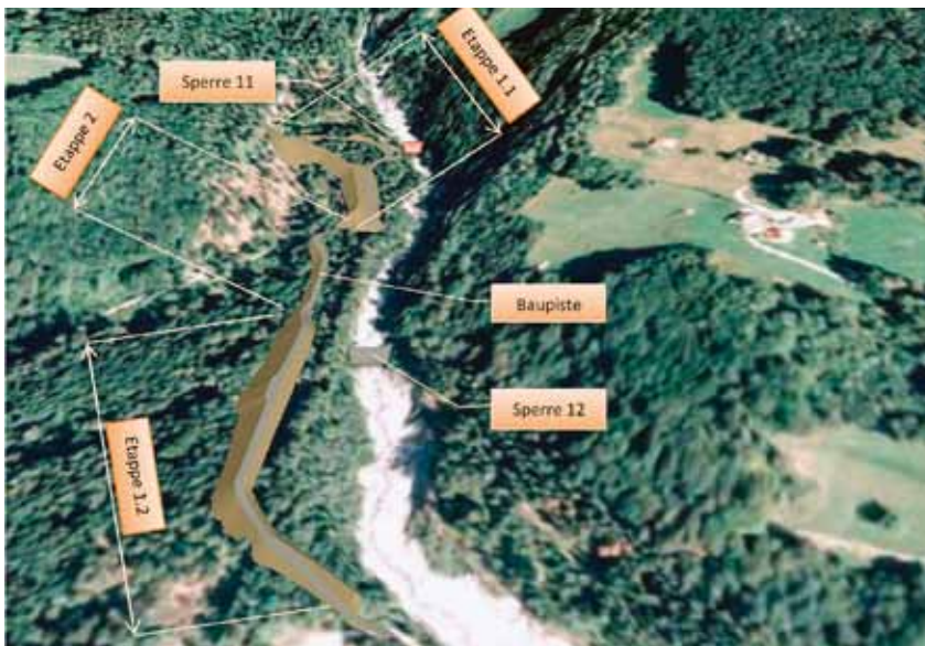
3D-Darstellung des geplanten Hochwasserschutzdamms am Eistlenbach.
